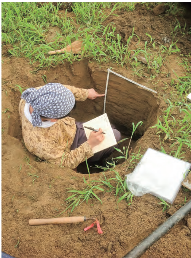
穴を掘り、洪水堆積物を観察する様子。上層にバラレルラミナが確認でき、下の層に行くにしたがって粒度が荒くなっていくのが確認できた
