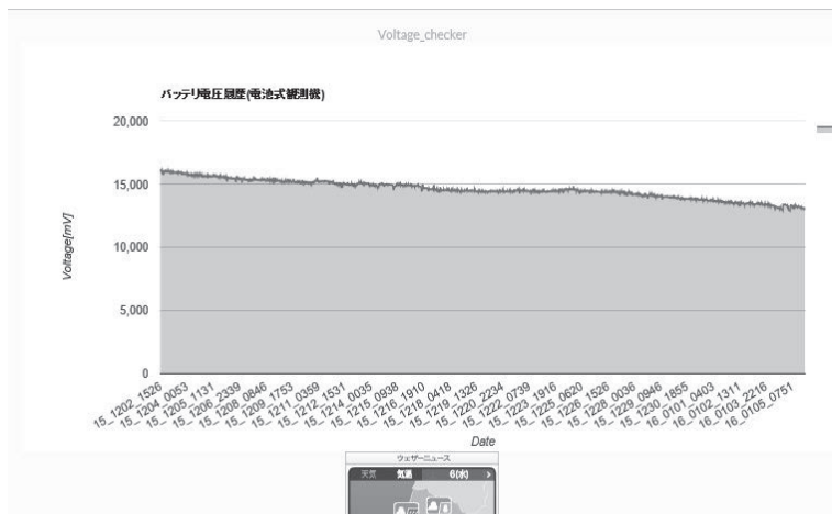
図-26 バッテリー電圧の変化 (2015年12月2日から2016年1月5日まで : 出典 筆者ら作成)
