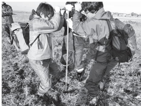
図-6 ピートサンプラーを用いた地質調査の様子
