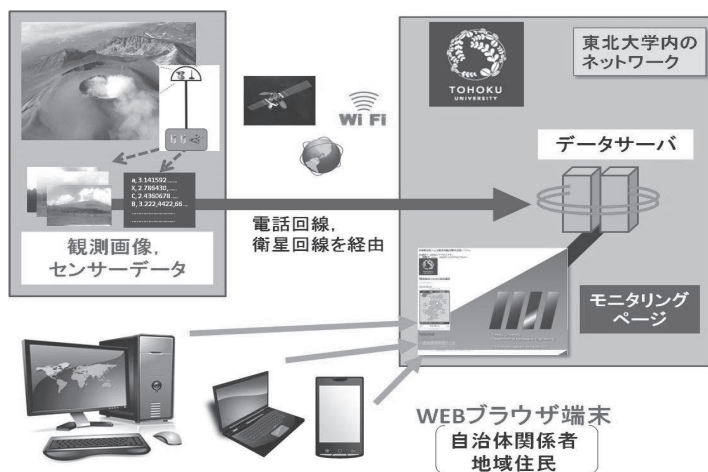
図 3-17 モニタリングシステムの概略図
