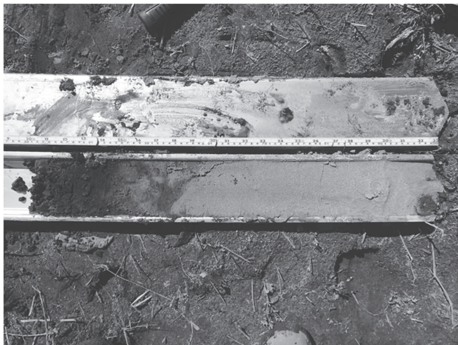
図-4 TK1 のボーリングで採取されたコアの様子
