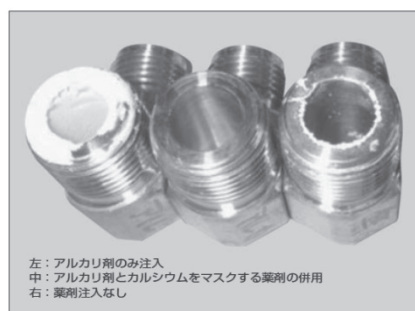
図-14 アルカリ注入法によるシリカスケールの抑制結果 [35]
