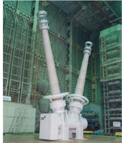
写真右: ガス遮断器 (Gas Circuit Breaker: GCB)。
